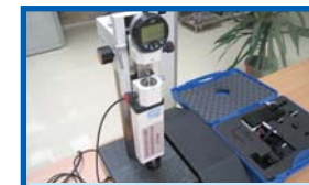
Aparat de etalonat/calibrat comparatoare pentru alezaje
