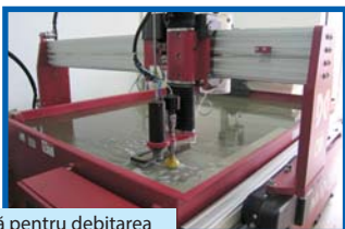
Mașină cu jet de apă pentru debitarea și prelucrarea epruvetelor
