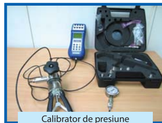
Calibrator de presiune 0-250 bar
