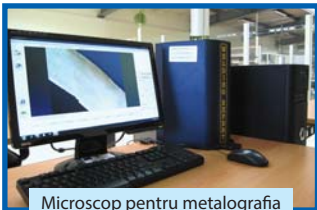
Microscop pentru metalografia și geometria sudurilor
