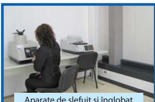
Aparate de șlefuit și înglobat probe metalografice
