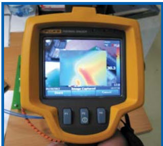
Aparat pentru determinarea defectelor electrice noncontact
