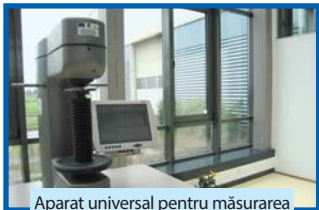
Aparat universal pentru măsurarea durității metalelor
