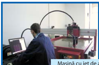
Mașină cu jet de apă pentru debitarea și prelucrarea epruvetelor
